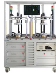
Stator BEMF test
